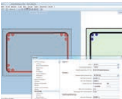
In Allplan 2014 wird der reale Stabdurchmesser sowohl in der Animation als auch bei der Kollisionskontrolle berücksichtigt
